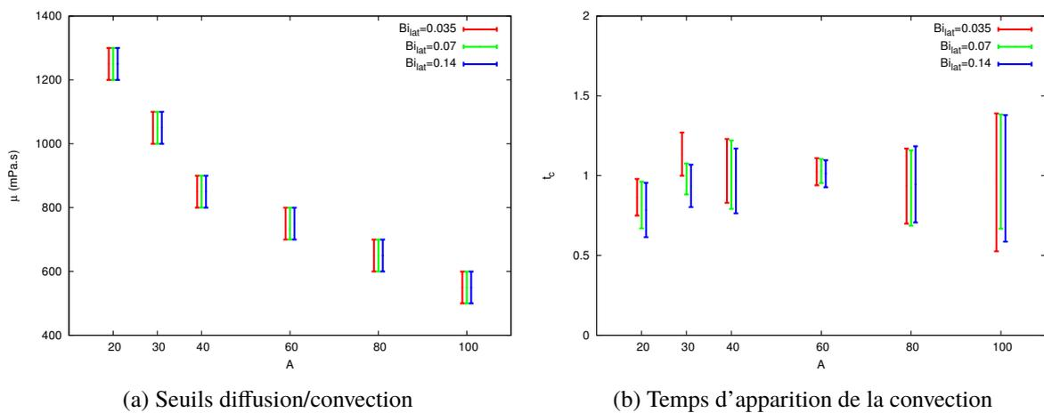
FIGURE 10 – Caractéristiques des transitions en fonction de l’allongement et du nombre de Biot latéral,  $e = 20 \text{ mm}$ .
