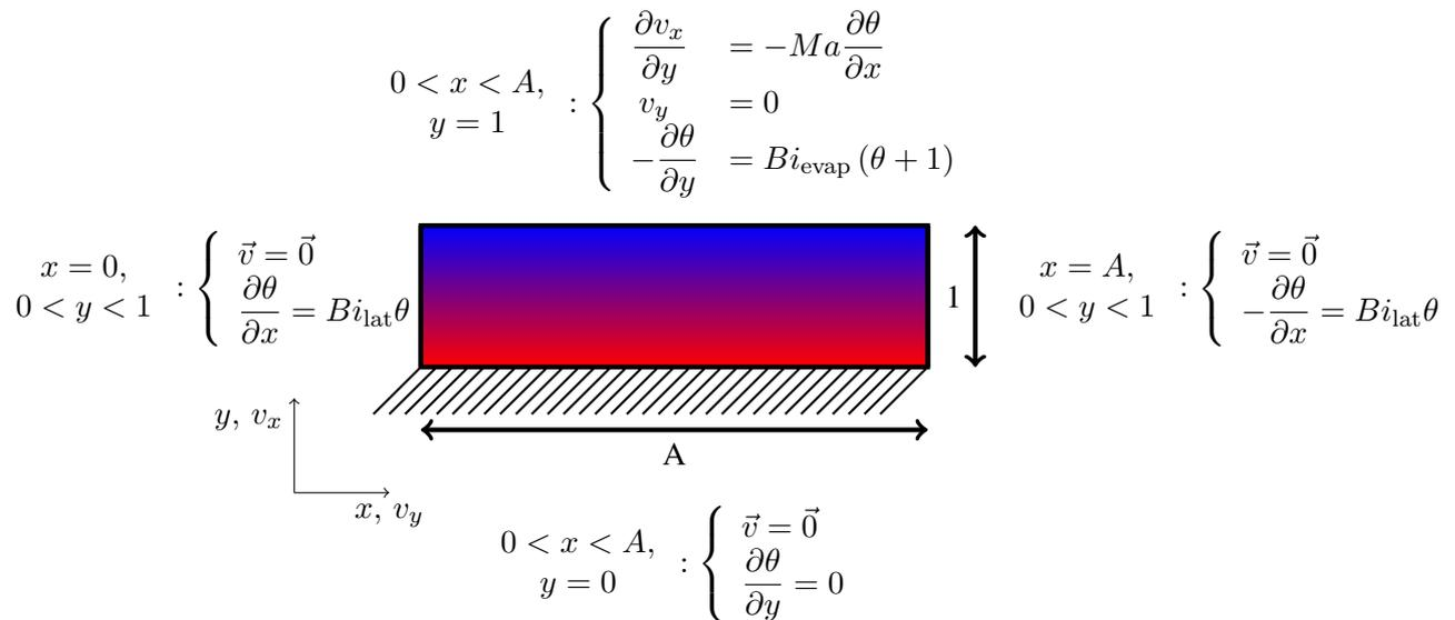
FIGURE 1 – Schéma expérimental
